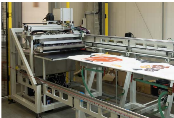
potisk panelů technologií DURAPRINT
